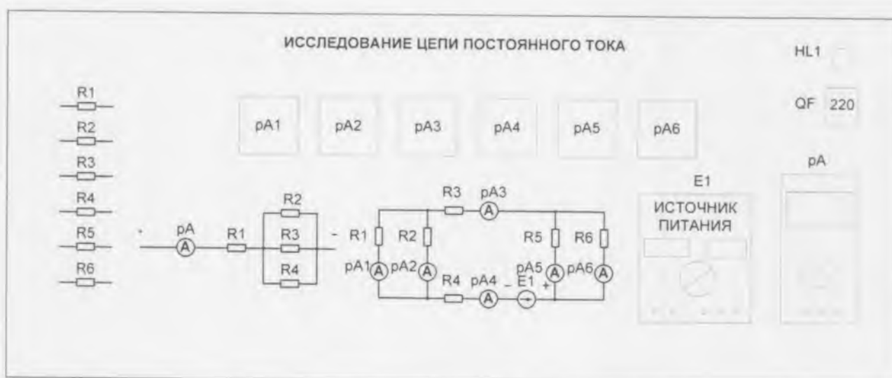
Рисунок 1.4 – Лицевая панель лабораторной установки
